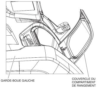
2. À l'aide d'un tournevis à tête plate, séparez le couvercle du compartiment de rangement aux points de fixation.
