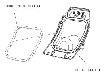
4. Fixez le porte-gobelet au compartiment de rangement en utilisant les points de fixation indiqués à l'étape 2.
